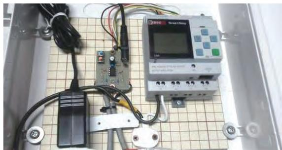
写真 簡易型ミスト装置の制御盤
