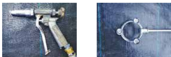
写真2 左：ピストル型噴口、右：三頭口型噴口
