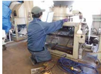
写真2 点検表に従って製茶機械を点検する様子
