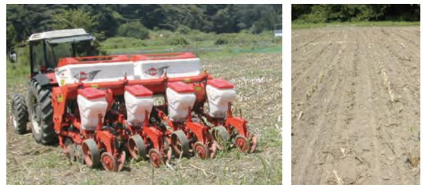
写真 不耕起播種作業（左） 同作業後（右）
