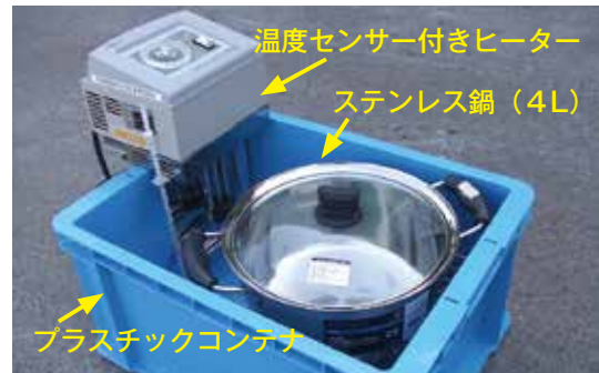
写真 初乳加温装置
