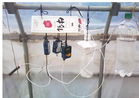
写真4 湿球・黒球・乾球温度の計測
