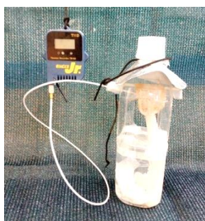
写真3 自作した湿球温度計
